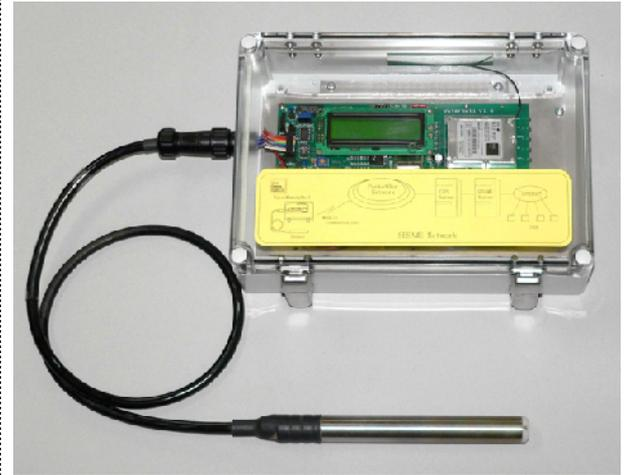
WaterMemoryNet1 は内蔵の乾電池で動作する水位測定装置です。小型（3W）のソーラーパネルを接続して運用することもできます。測定データは内部に記録され、定期的に、またはリアルタイムに無線通信で送信することができます。ユーザーはインターネットを通してアクセスするだけで、記録されたデータを取得することができます。これによりリアルタイムで確実な計測が行うことができます。水位を検出する水位センサーは大気圧補正型の0.1%高精度センサーを使用しています。また、WaterMemory 以外にも WindMemory（風向風速計）、MultiNet1（多チャンネル多要素型データロガー）も通信モジュール搭載可能です。
